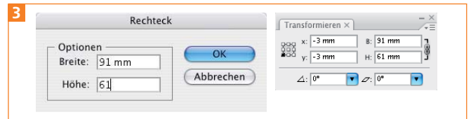
Das Rechteck markiert die übliche Beschnittzugabe von 3 mm.
