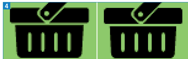
Die horizontalen und vertikalen Kanten links liegen nicht auf ganzen Pixeln und sind daher nicht scharf.
