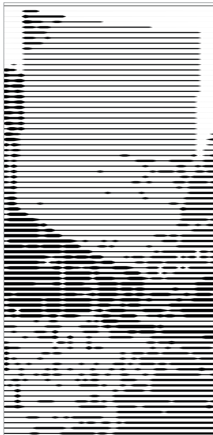
Rasterpunkt: Linie, Zunahme: abgestuft, Muster: gerades Rastergitter, Verzerrung: keine
